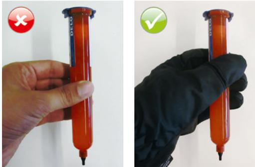
Bitte achten Sie darauf, gefrorene Gebinde möglichst geringflächig zu berühren, da ein großer Temperaturunterschied zwischen Gebinden und Klebstoff zum „Ablösen“ des Klebstoffs von der Kartuscheninnenwand führen kann. Empfohlen wird die Entnahme am hinteren Ende des Gebindes oder die Verwendung von wärmeisolierenden Handschuhen.
